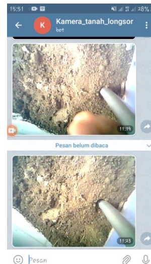
Gambar. 16. Hasil capture ESP32-CAM ke telegram
