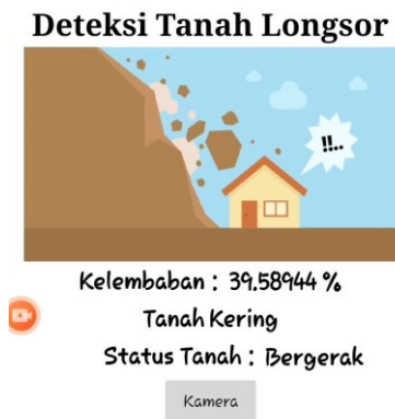
Gambar. 8. Hasil tampilan kondisi tanah kering dan bergerak
